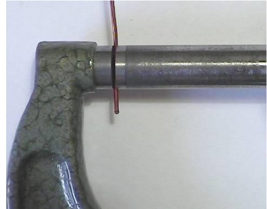
Detalle de medida con micrómetro
