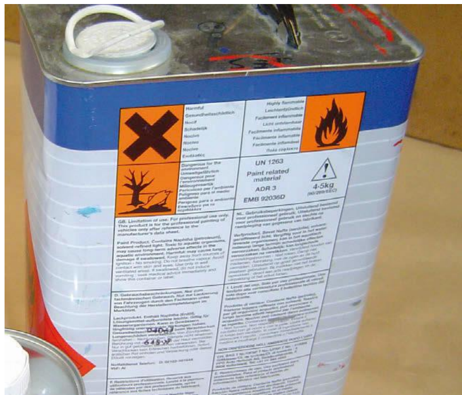
Figura 1.50. Marcado de productos peligrosos.
