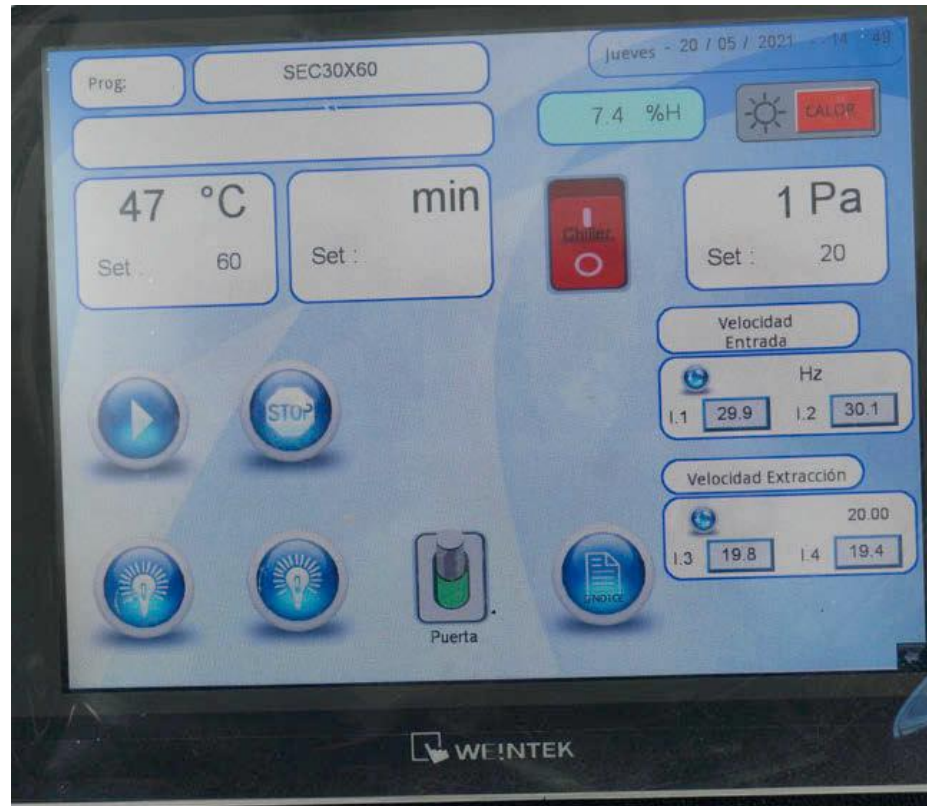
Figura 1.7. Temperatura de cabina.
