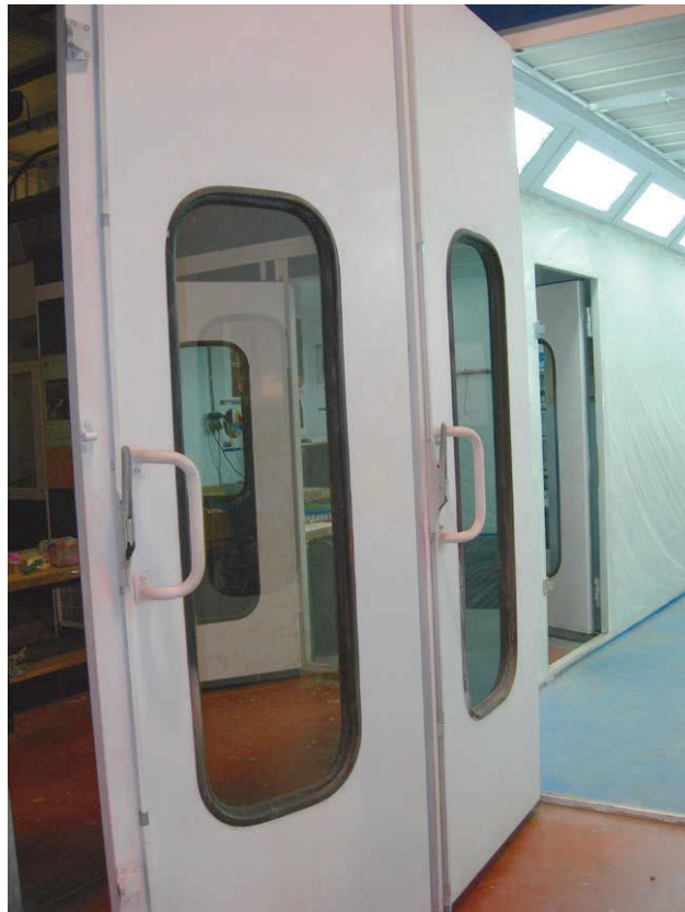
Figura 1.40. Puertas de la cabina de pintura.
