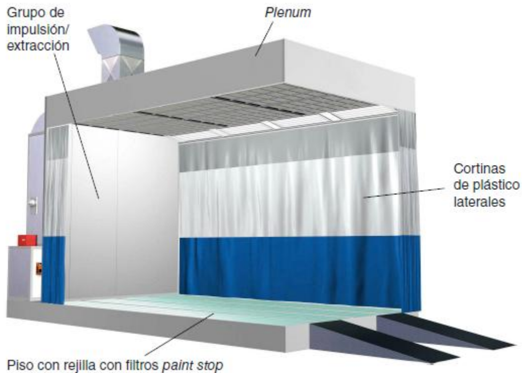
Figura 1.19. Plano de aspiración con piso con rejilla.
