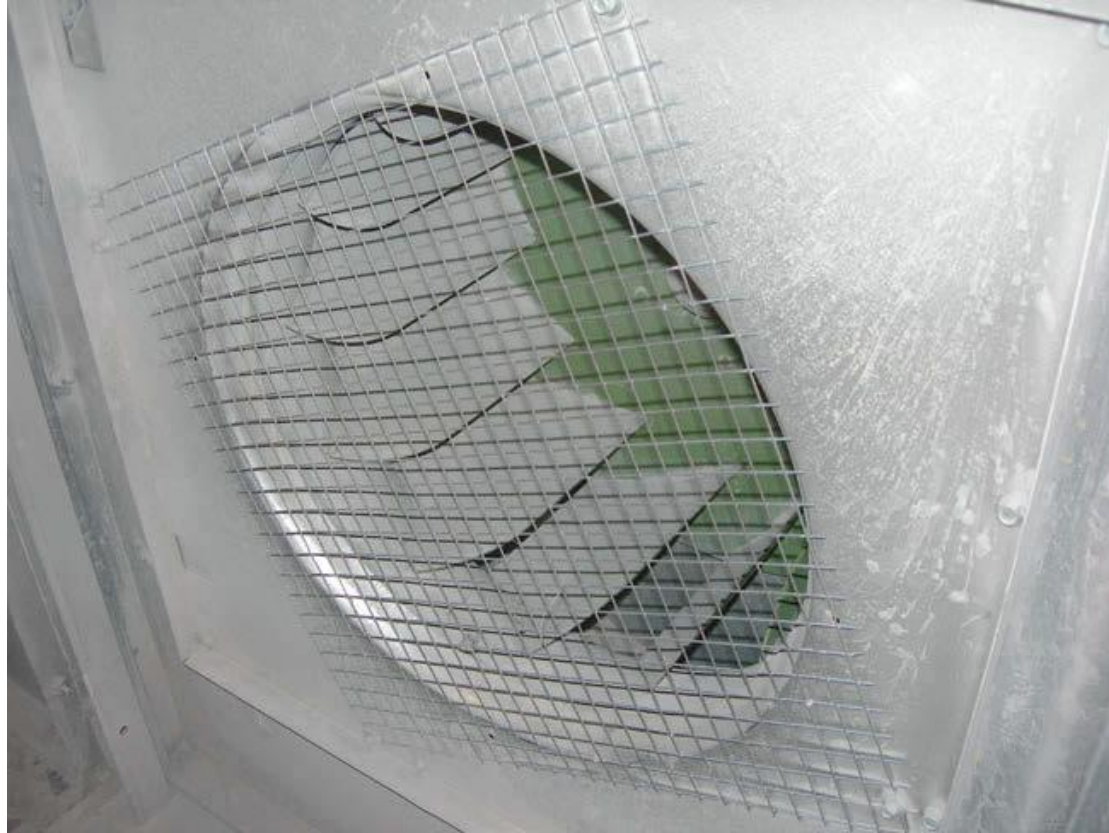
Figura 1.20. Aletas del grupo extractor del plano aspirante.
